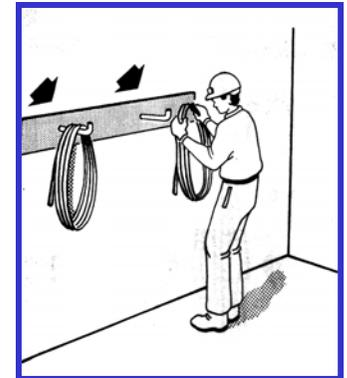
Las eslingas deberán ser verificadas al devolverlas al almacén, retirando aquellas deformadas por el uso, corrosión, rotura de filamentos, etc..
