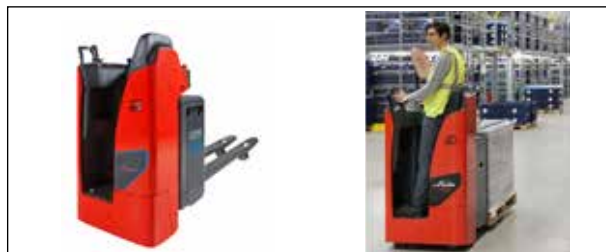
Figura 4. Transpaleta eléctrica tipo conductor incorporado.
